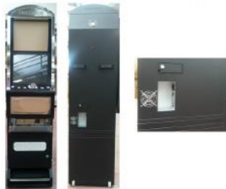
PRESTIGE CON ALIMENTATORE ACCESSIBILE SOLO DALL'INTERNO
